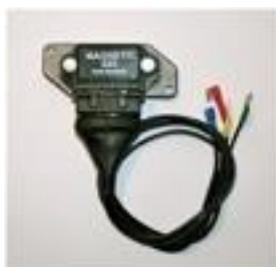
**LE MPA :** Module d'assistance des rupteurs ; ne remplace pas les rupteurs, limite simplement leur usure
